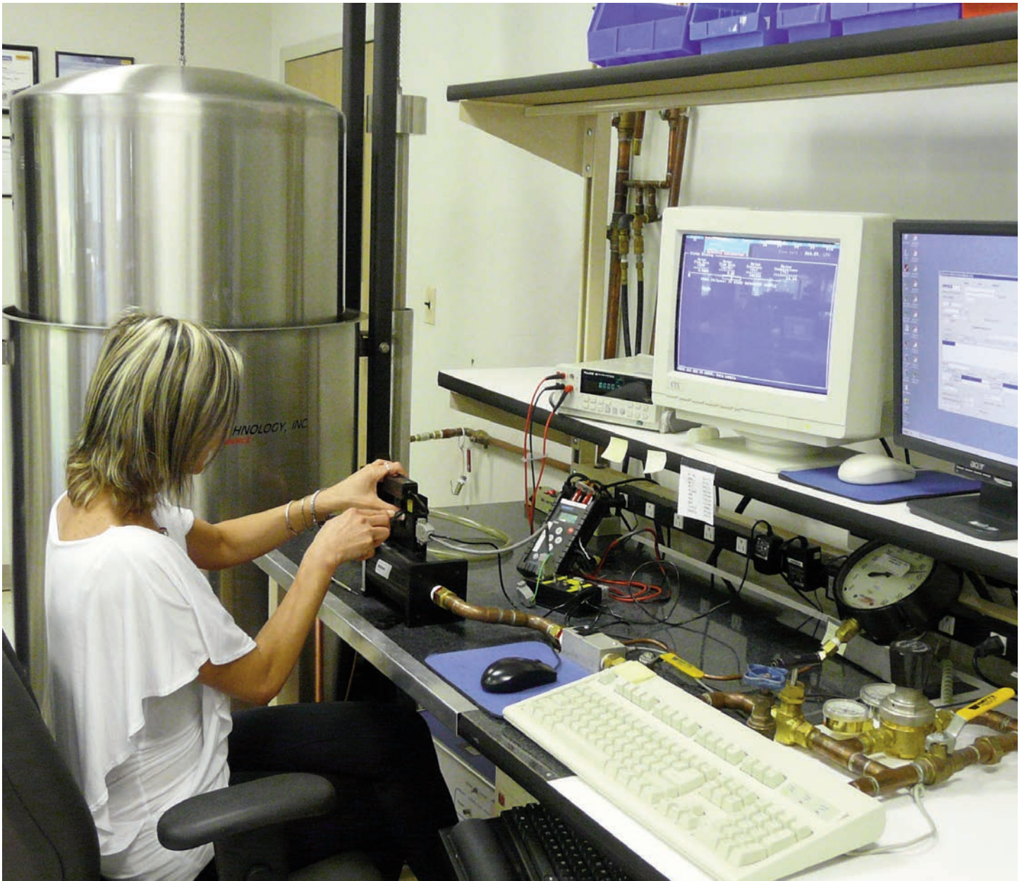
Benutzung eines Bell Prover durch eine Technikerin bei der Kalibrierung eines Durchflussmessers mit hoher Durchflusskapazität.
