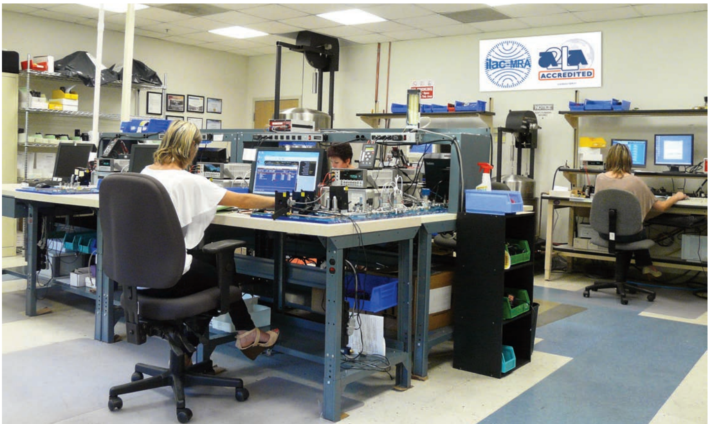
Techniker kalibrieren Massenflussregler unter Verwendung von Prüfglocken und Molbox/Molblochs-Technologie.
