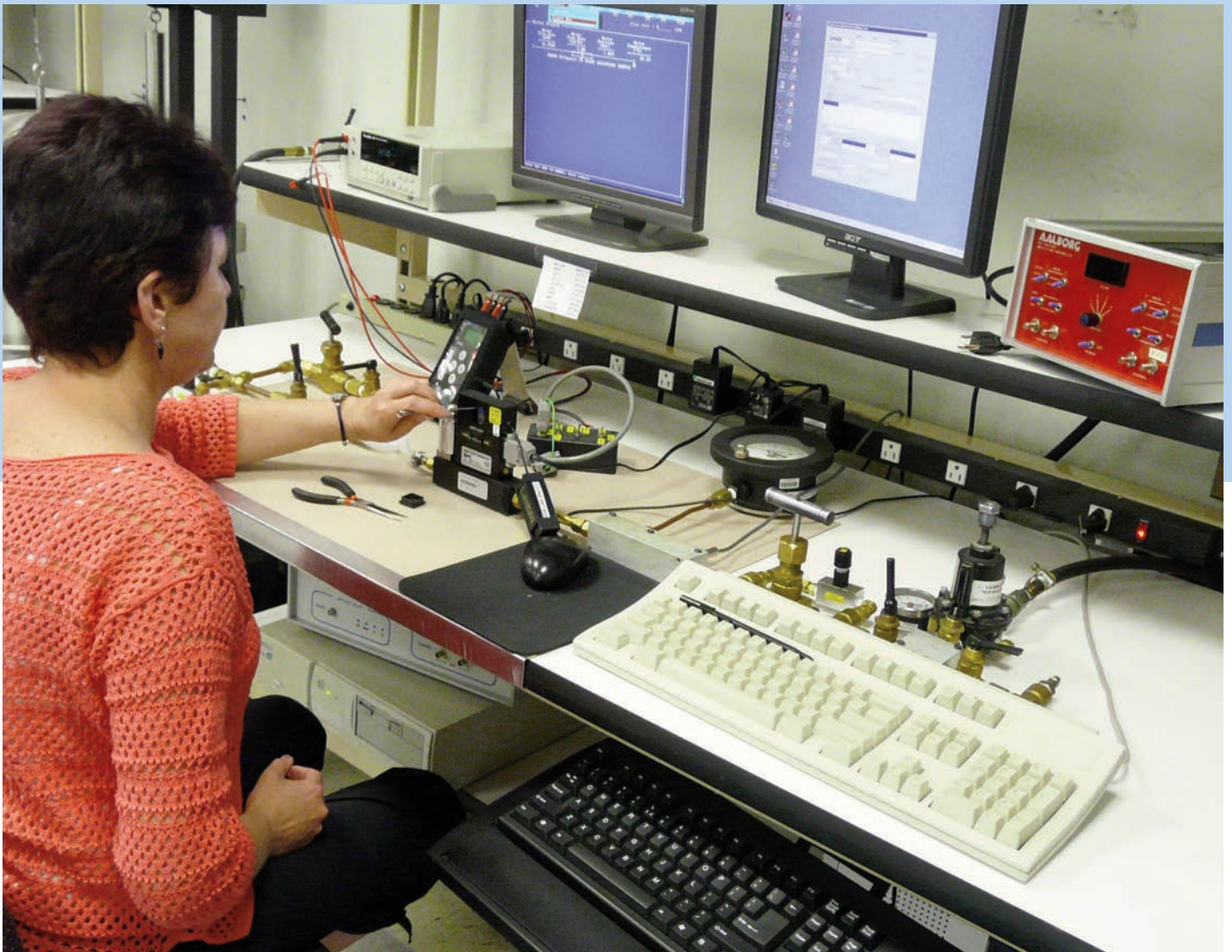
Terminal für die Kalibrierung eines Niedrigdurchfluss-Reglers unterstützt durch Aalborg SDPROC- Software.
